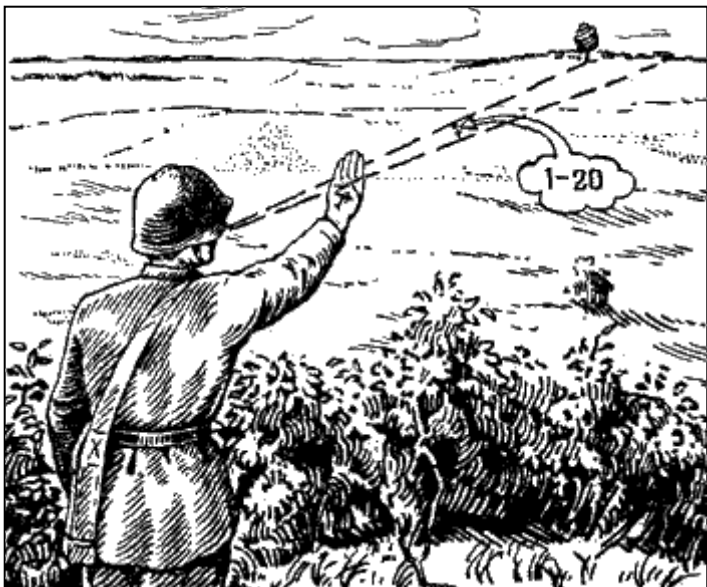
Рис. 179. Ваши пальцы могут служить вам простейшим угломерным прибором
